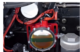
Automatisches Schmierölbetankungssystem Automatic lube oil refuelling system
