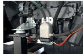
Kühlmittelheizung Water heater
